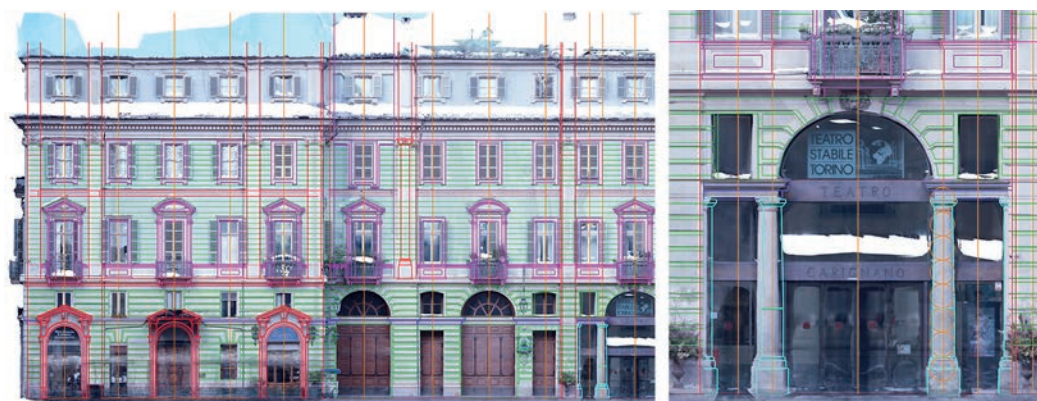
Fig. 5. Rilievo e analisi grafica sovrapposta all'ortofoto della facciata del Teatro Carignano. Elaborazione di M. Rinascimento.
