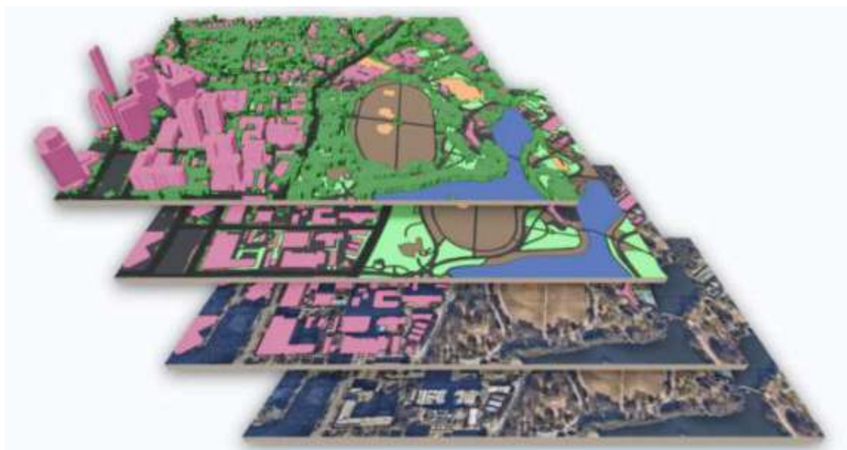
Fig. 1. Illustrazione di come le immagini geospaziali vengono utilizzate per creare un Digital Twin (ricostruzione digitale di Ecopia).
