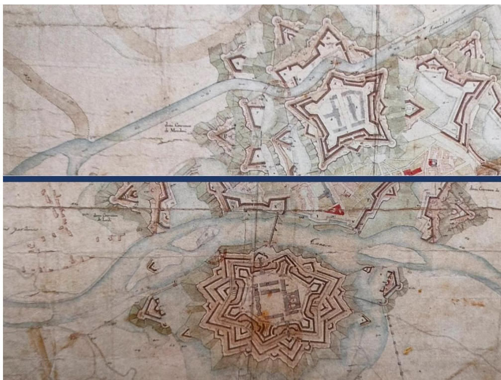
Fig. 2- Dettagli del successivo progetto di Chasseloup-Laubat in cui spiccano le varie componenti del sistema difensivo, in cui l'acqua dei due fiumi assume un ruolo fondamentale (Barghini, 1991: p. 56)
