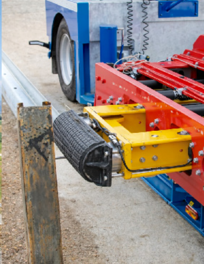
Figura 2, a lato: Prova di carico dinamico su paletto (a sinistra metodo con massa oscillante).
