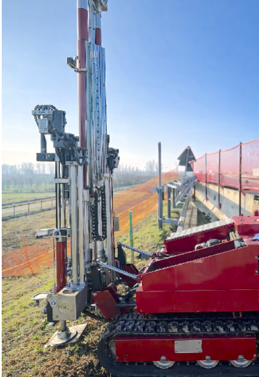
Figura 6: Prova penetrometrica dinamica (DPSH) in sito, eseguita in prossimità alla prova di push (figura 4).
