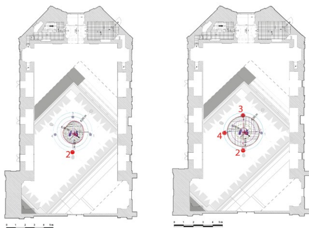
Figura 1 - Schema delle sorgenti e dei solidi di direttività: (sx) sorgente naturale con direttività violinista; (dx) sorgente composta per la ricostruzione del campo sonoro tramite settorializzazione dell'emissione in 4 angoli solidi.
