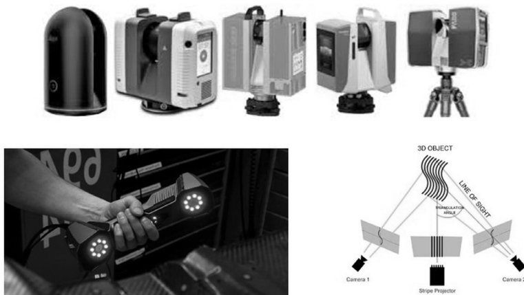
Figura 4 Sistemi a scansione.
