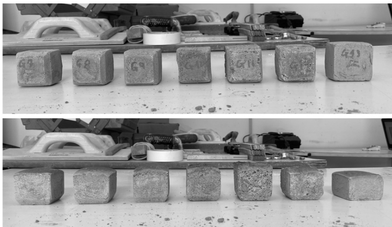
Figura 4. Provini sviluppati con combinazione di cocciopesto, soluzione geopolimerica e calce aerea [Fonte: autore].
