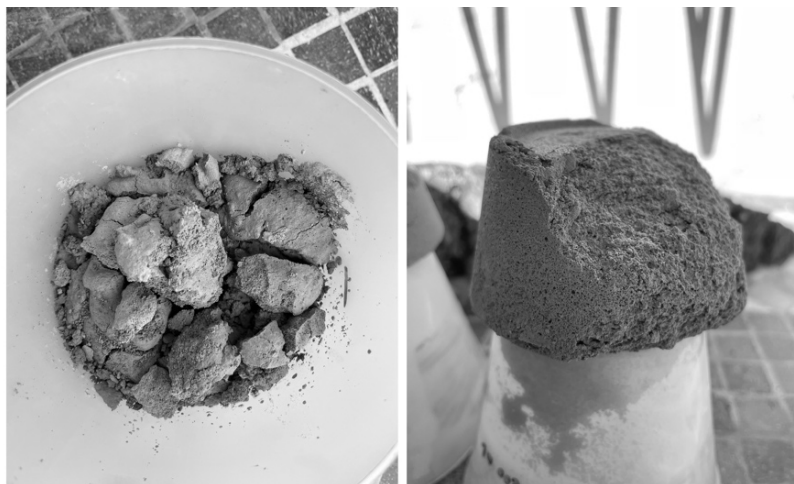
Figura 2. Frantumazione (sinistra) e disgregazione (destra) dei campioni sviluppati nel corso della prima campagna sperimentale [Fonte: autore].
