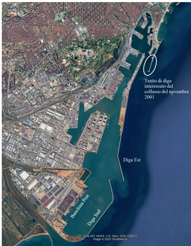
Figura 2. Opere di difesa costiera del Porto di Barcellona (fotografia aerea del 2025 tratta da Google Earth).
