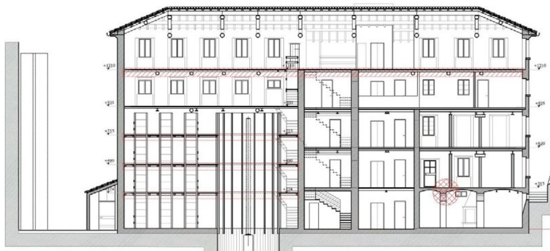
Fig. 3. Sezione longitudinale del setificio con evidenziati gli impalcati da consolidare (@Architetti Maiorana e Castiglioni, 2016) 4 .
