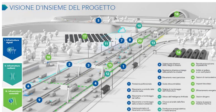
FIGURA 30. VISIONE DI INSIEME DEL PROGETTO DI “INNOVAZIONI TECNOLOGICHE PER LA TRANSIZIONE ECOLOGICA” DELL’AUTOSTRADA A4 TORINO-MILANO.
