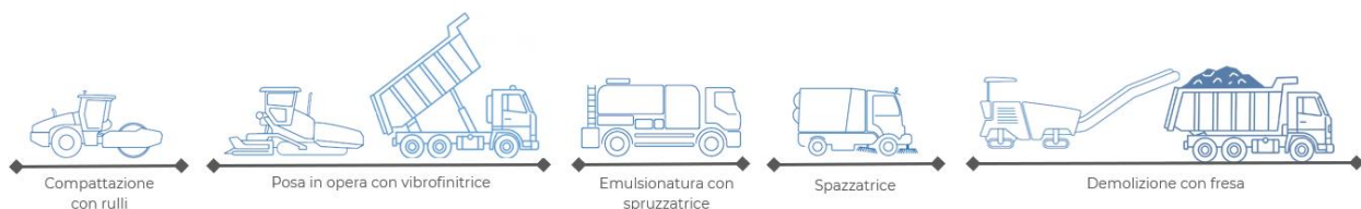
FIGURA 9. TRENO DI LAVORAZIONE PER LA MESSA IN OPERA DEI CONGLOMERATI BITUMINOSI.
