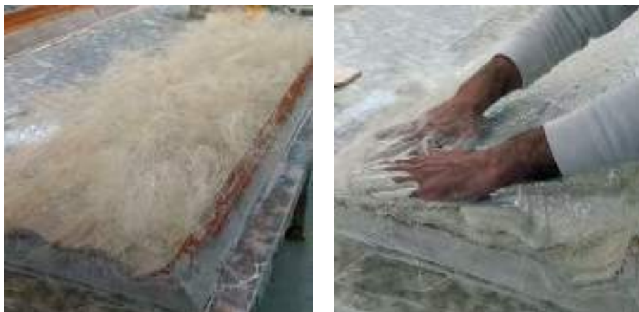
Figg. 3-4_ Realizzazione presso la ditta Montanaro a Torino di un elemento decorativo a stucco con l'utilizzo di fibre vegetali per aumentarne la resistenza.
