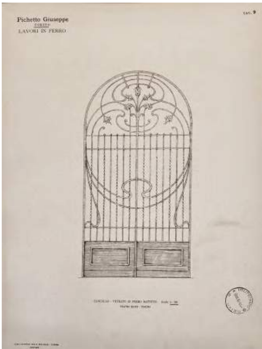
Fig. 1_DITTA GIUSEPPE PICHETTO, Cancello vetrato in ferro battuto , Teatro Eden, Torino, edito in GIUSEPPE PICHETTO, Lavori in ferro Gerardo Molfese Editore, Torino [19..], Tav. 9.
