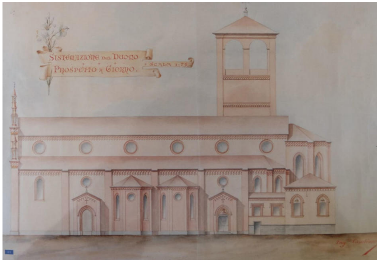
Fig. 2 - Prospetto meridionale inerente il progetto di Stefano Cambiano per l'inserimento delle cappelle, dell'ingresso e per la sistemazione della zona absidale. La prefigurazione, che risale al 1888 e verrà realizzata in due lotti successivi, mostra per la parte tergale della chiesa il riferimento alle finestre dedotte dalla Casa del Senato (ASCP, Urbanistica P III 36 – (3) – Parte I 190).
