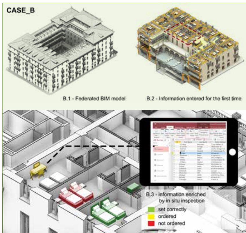
Figura 3 - Flusso di lavoro per la registrazione dei dati in cantiere relativo al posizionamento degli arredi per l'ex Albergo di Virtù, in Torino (fonte: per gentile concessione dell'arch. F. De Giuli. Elaborazione grafica e modello di registrazione dei dati a cura dell'autore).
