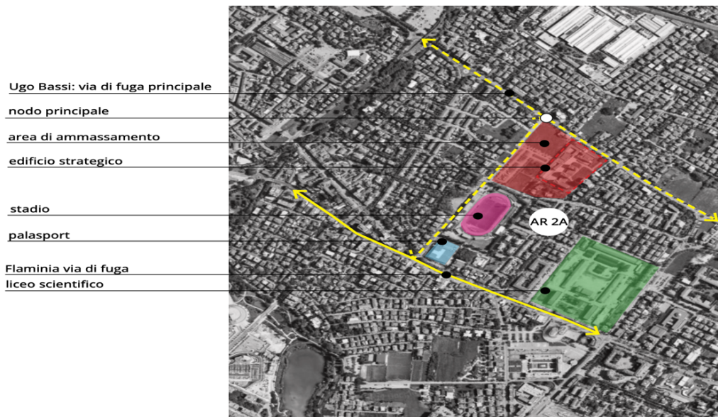
Figura 2 | Rimini - Il progetto urbano di valenza strategica per il comparto attuativo AR_2°.
