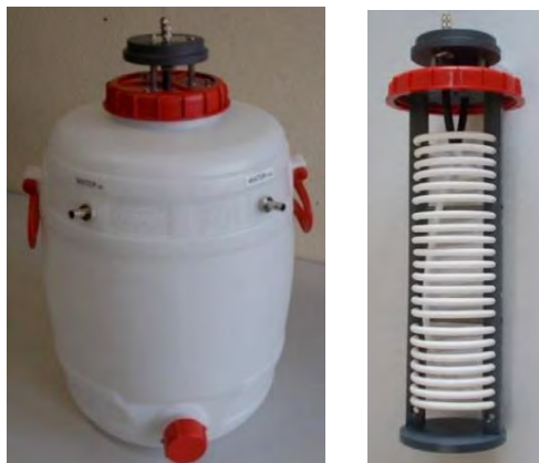
Figura 5 - Sistema REM2 - Alphaguard (Bertin)
