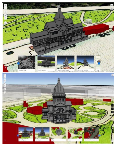
Figura 7. Applicazione WebGIS con modello BIM integrato rispettivamente del Padiglione del Siam (alto) e della Città di Torino (basso), da Spreafico et al., 2023.
