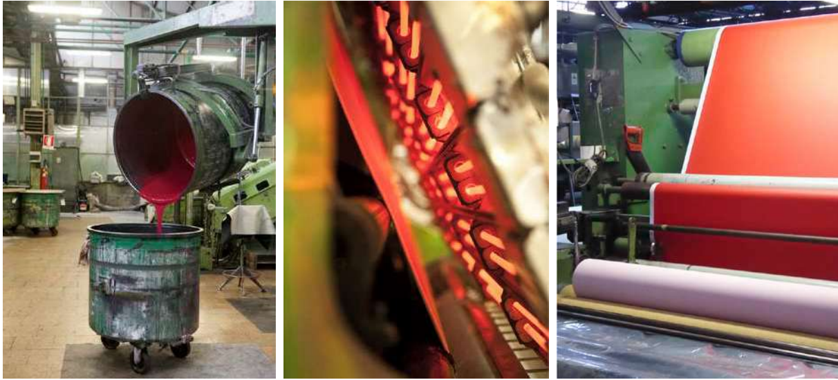
Fig. 3. Alcune fasi del processo produttivo all'interno dello stabilimento Resinflex in via Reiss Romoli, Torino. Da sinistra: fasi di miscelamento delle paste con i pigmenti, il forno di gelificazione (fotografie di L. Ferrando-Archivio Resinflex), fasi di controllo e collaudo (fotografia di T. Marzi).
