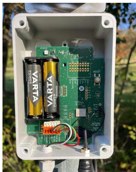
Fig. 2 - PCB integrating microcontroller and LoRa radio Fig. 2 - PCB che include microcontrollore e radio LoRa
