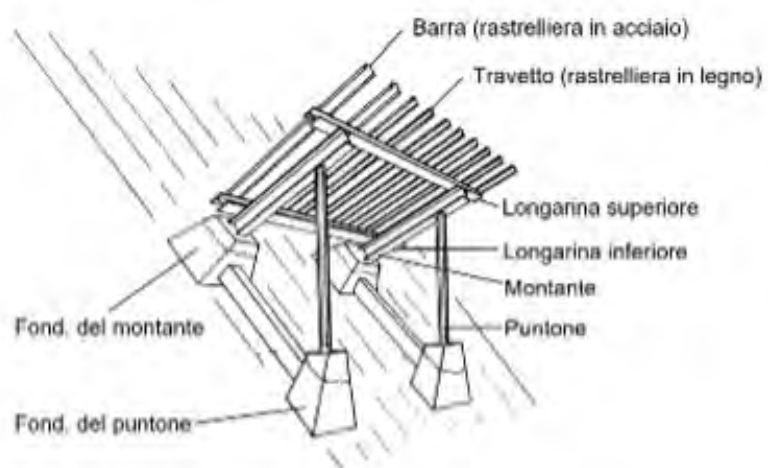
Figura 4.2 - Schematizzazione di una rastrelliera da neve (adattata da Margreth, 2007).
