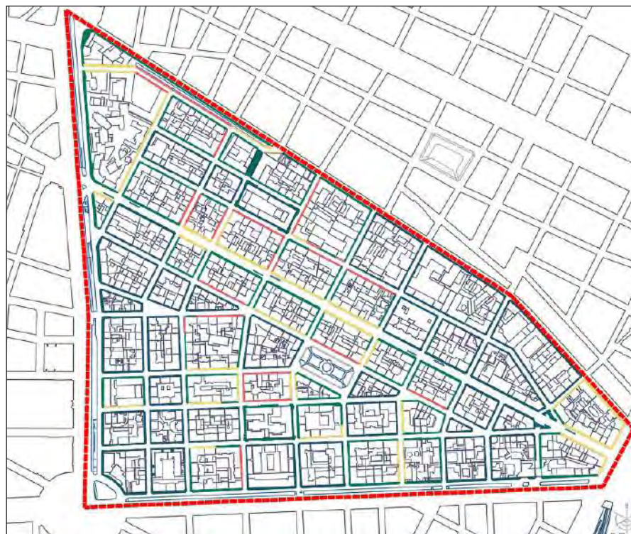
Fig. 24/ Planimetria dello stato di conservazione della pavimentazione dei marciapiedi, dove con una diversa gradazione di colore sono state individuate 3 diverse valutazioni degli stati di conservazione: verde | buono/sufficiente; giallo | degradato; rosso | molto degradato. (Rilievo diretto a cura dell'autrice e da Geoportale, aggiornato a settembre 2024).
