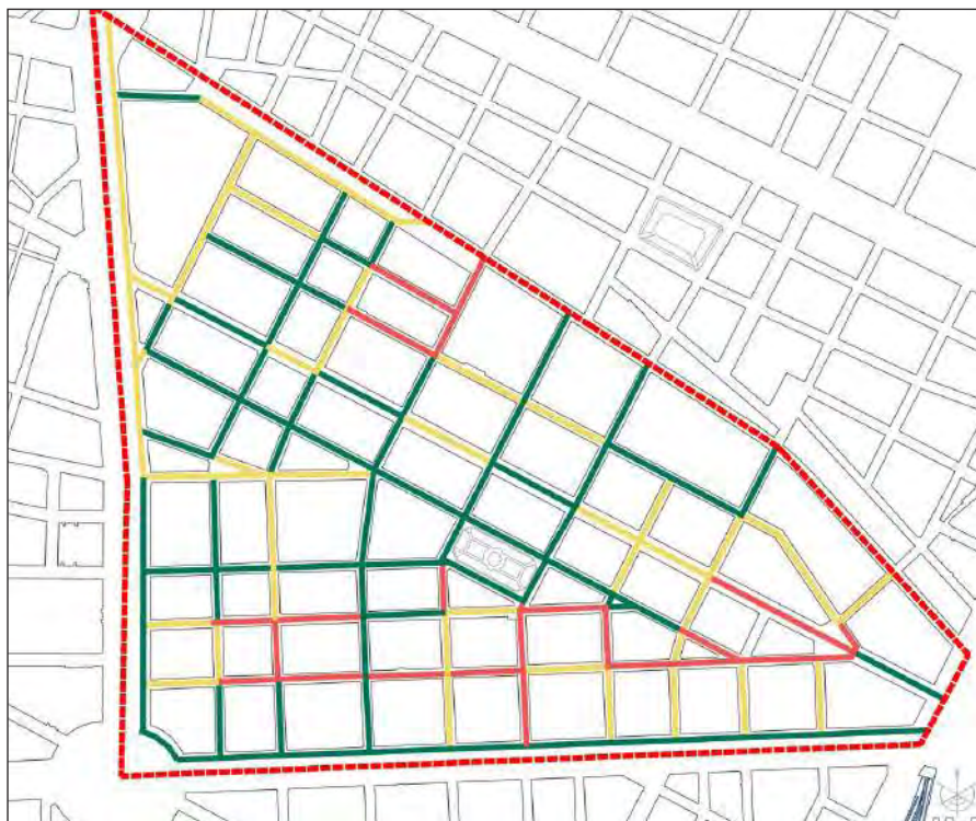
Fig. 19/ Torino, Quartiere San Donato, planimetria dello stato di conservazione del manto stradale, dove con una diversa gradazione di colore sono state individuate 3 diverse valutazioni degli stati di conservazione: verde | buono/sufficiente; giallo | degradato; rosso | molto degradato. (Rilievo diretto a cura dell'autrice e da Geoportale, aggiornato a settembre 2024).
