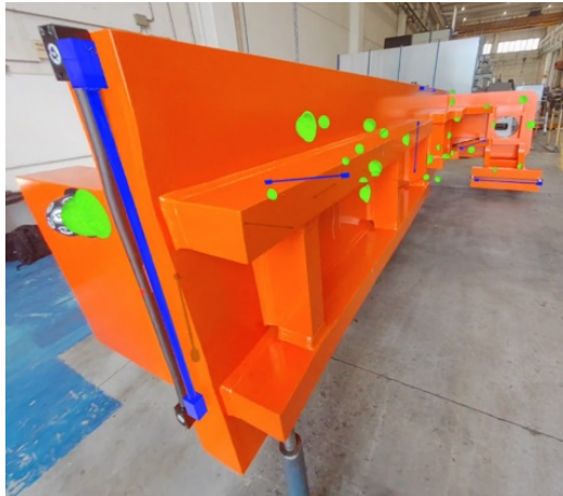
Figura 6. Visualizzazione AR del pezzo da lavorare con sovrapposti i modelli digitali dei componenti aggiuntivi da posizionare.
