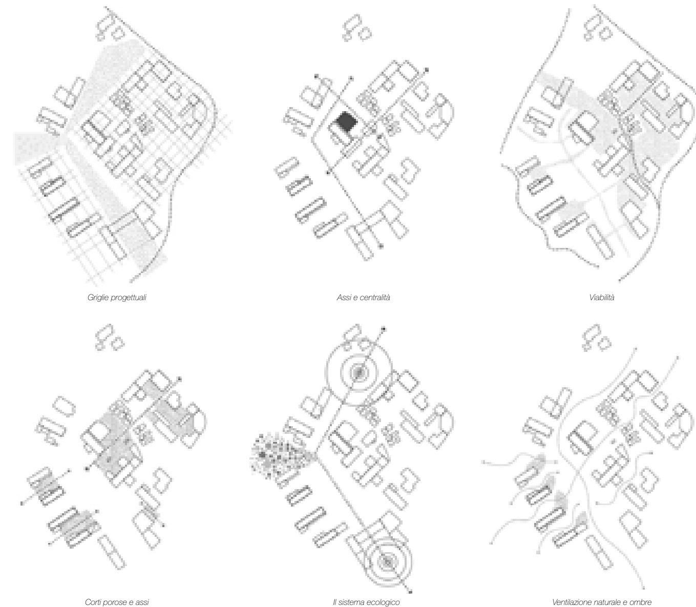
Analisi urbane (griglia, assialità, viabilità, cortili, corridoio ecologico, ventilazione). Elaborazione M. Scarpellino, 2018.
