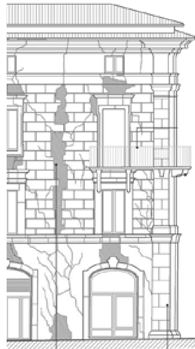
A sinistra: Quadro fessurativo facciata sul corso (el. Nardisarchitetti, L'Aquila 2014). A destra: Nuovo finto bugnato ad intonaco dopo gli interventi di restauro (ph. G. Mastrangelo, 2019).
