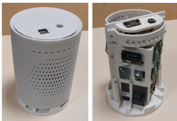
Figura 1 - Fotografia del multi-sensore e della disposizione dei suoi componenti interni.
