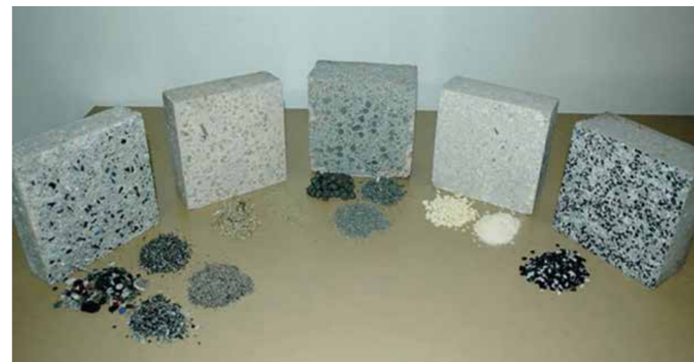
Sperimentazioni di calcestruzzo riciclato da: https://https://www.architetturaecosostenibile.it/
