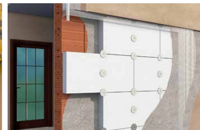
Realizzazione del cappotto termico da www.isolkappa.it
