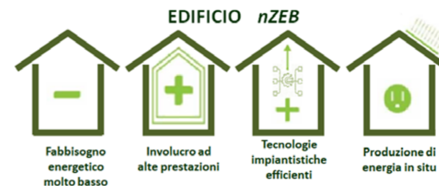
Caratteristiche di un edificio NZEB da https://pnpe2.enea.it
