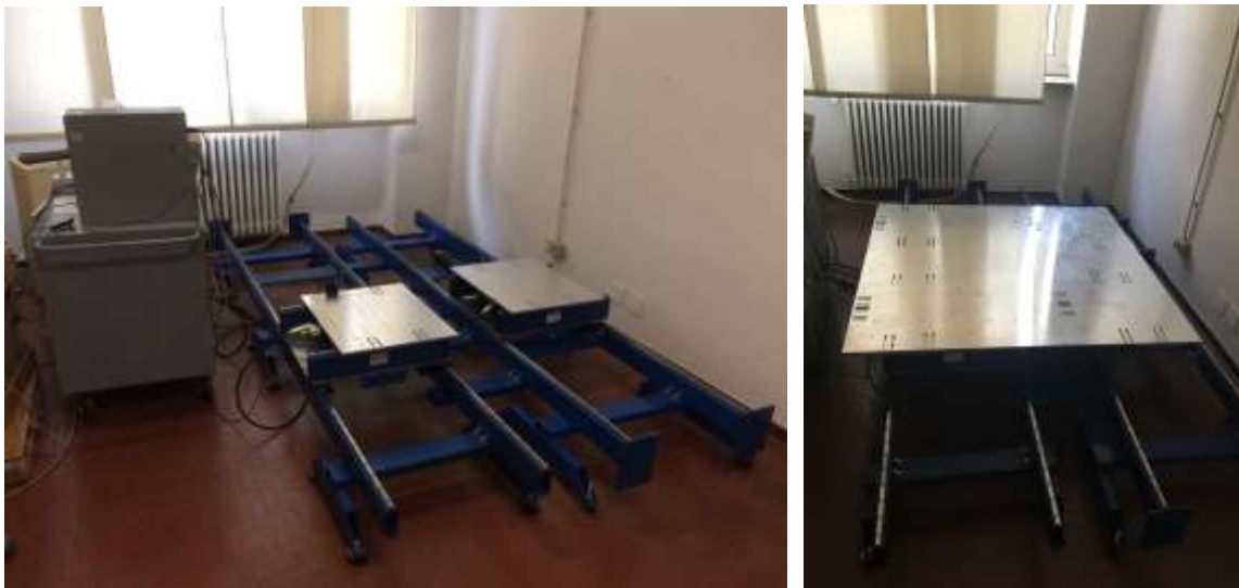
Figure 8. Shaking table at Politecnico di Torino.
