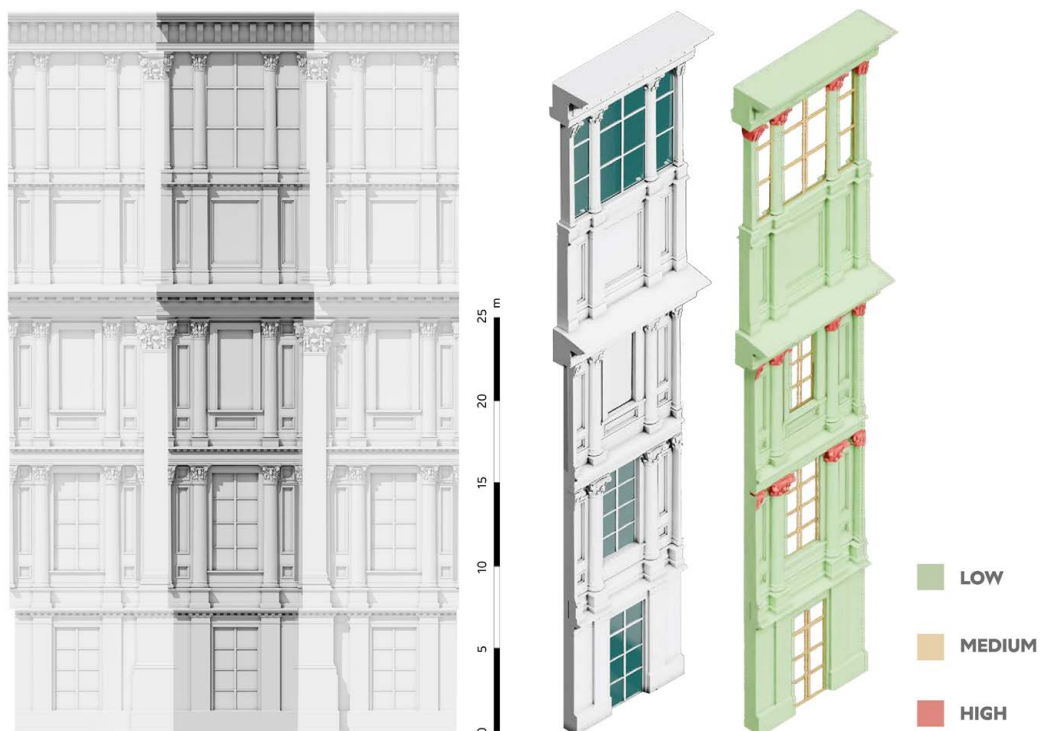
Fig. 5. Level of References - LoRef (da: Giovannini 2017) applicato agli elementi del "modello dinamico". Elaborazione di L. Torresi.
