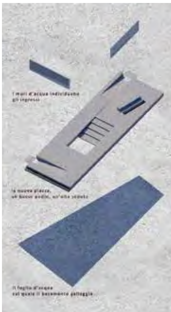
Fig. 6 Gli elementi che compongono la piazza.
