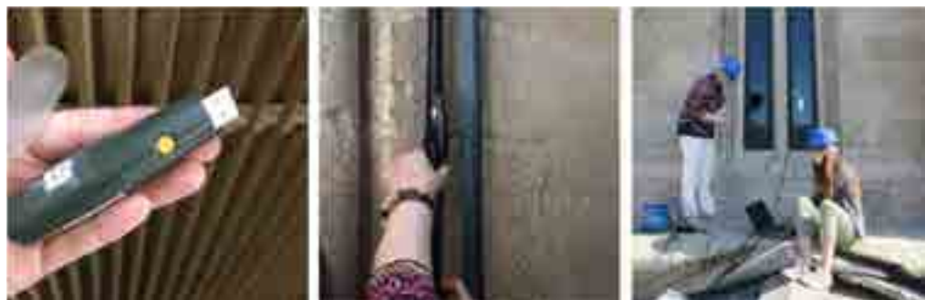
1: Sonde USB di temperatura e umidità relativa e loro posizionamento in sito.
