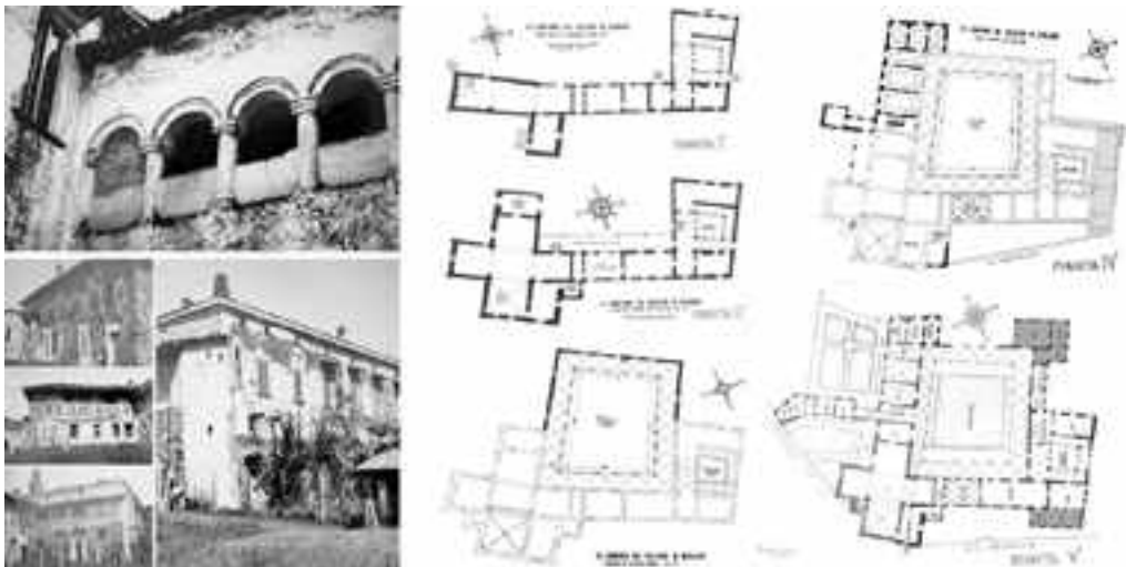
5: (a sinistra) Il convento dei Celestini a Bergamo: foto dello stato di fatto, s. d. e (a destra) ricostruzione grafica delle fasi costruttive redatta da Luigi Angelini. Su questo schema Angelini elabora la proposta di sistemazione - pianta V, 1938, in basso. Secondo una rielaborazione dell'autrice, sulla pianta IV sono riportate in grigio chiaro le demolizioni effettuate nel corso del restauro e sulla pianta V, in grigio scuro, le nuove costruzioni progettate da Angelini (@ BCBg, Archivio Luigi Angelini, Progetti, ANG. D 5782-5857).
