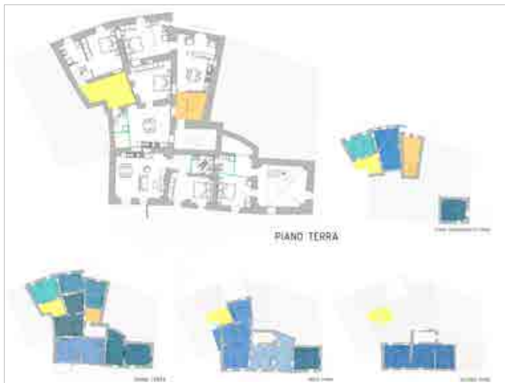
4: Planimetrie ai vari livelli, con evidenziata la nuova distribuzione interna. Sono evidenti le disposizioni in funzione dei nuovi corpi scala e patii e degli appartamenti (dodici complessivi) in funzione delle varie colorazioni associate (giallo e arancione per ingresso/patio/corpo scala, altri colori per i dodici appartamenti).
