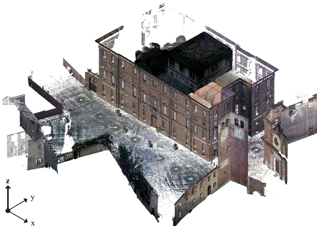
Fig. 11: Palazzo Grosso e contesto, vista assonometrica della nuvola di punti da rilevamento range-based . Elaborazione: F. Natta
