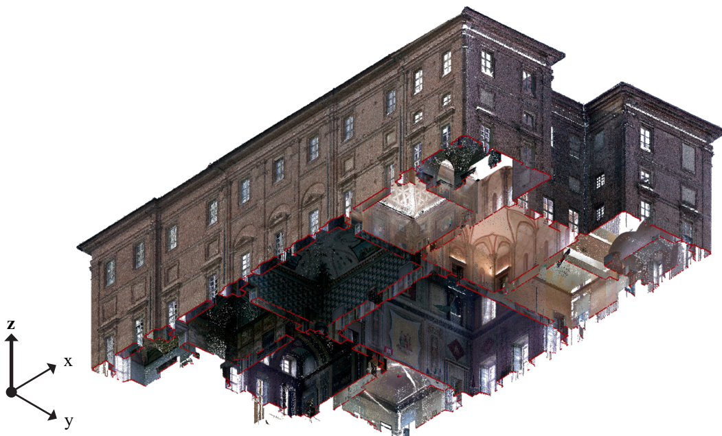
Fig. 12: Piano nobile di Palazzo Grosso, vista assonometrica della nuvola di punti da rilevamento range-based . Elaborazione: F. Natta
