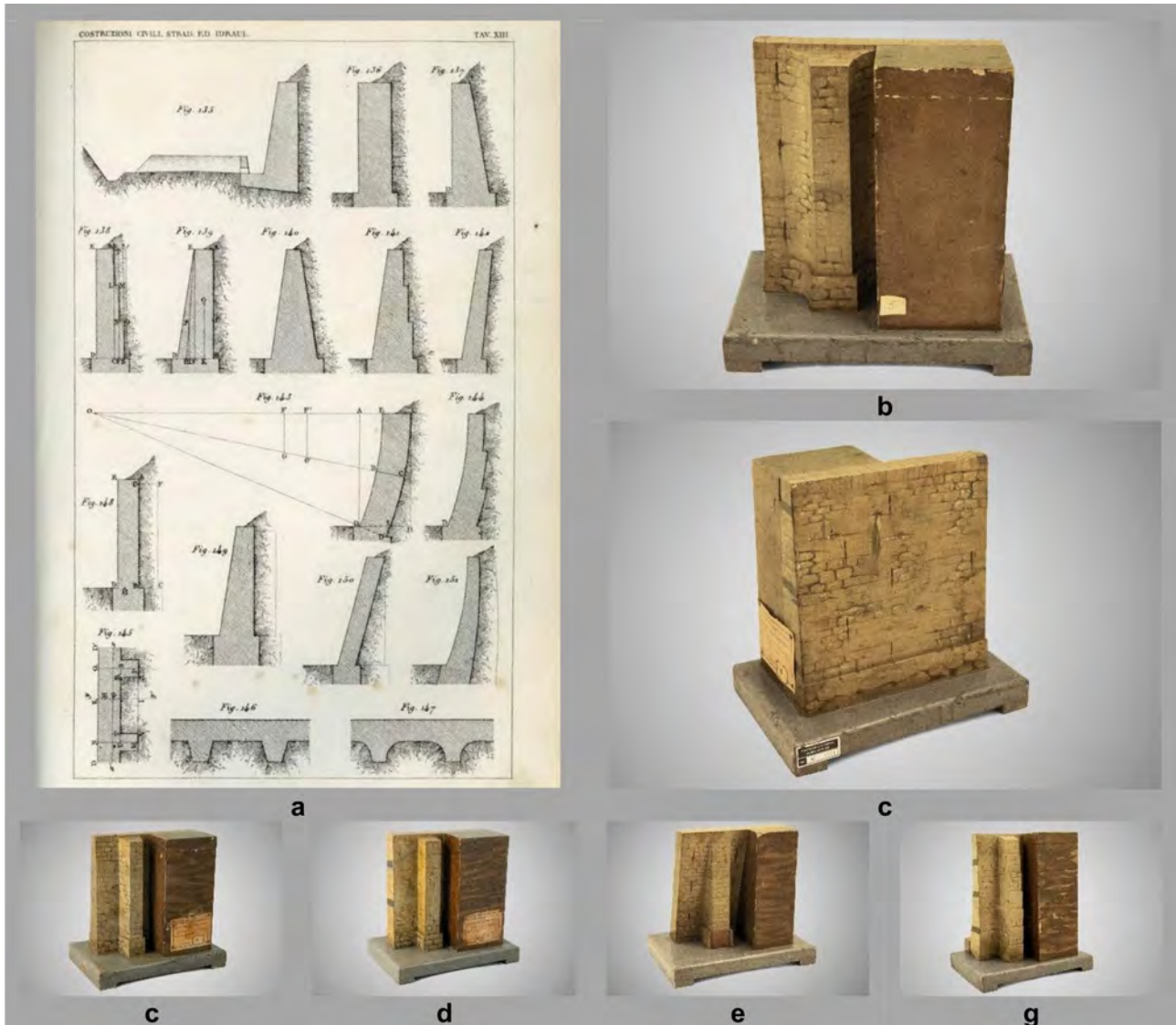
Fig. 1. Muri di contenimento con contrafforti interni. a) Curioni 1870. Tav. XIII; b-c) m.5, dim. 240x240x155 mm; d) m.1, dim. 245x250x160 mm; e) m.2, dim. 235x250x160; f) m.3, dim. 255x260x170; g) m.4, dim. 290x250x180 (elaborazione grafica di M. Pavignano).
