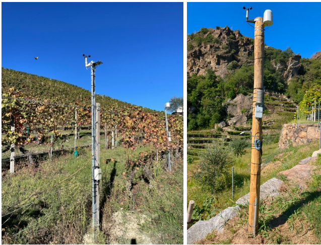
Fig.2 – Esempio di stazione meteo contenente un sensore di temperatura e umidità del terreno, vento e radiazione solare (sul palo in primo piano), pioggia, temperatura e umidità dell'aria e bagnatura fogliare sul palo in secondo piano a destra.
