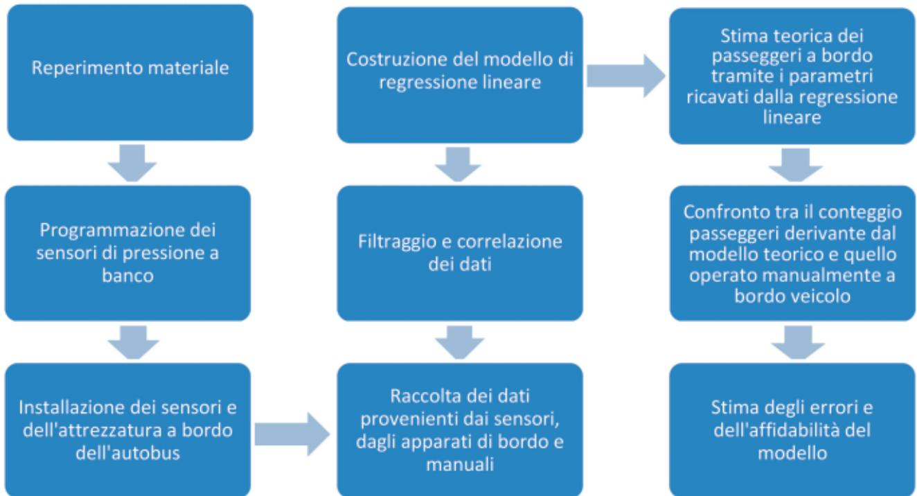
Figura 5 – Schema del processo di analisi e conteggio adottato.
