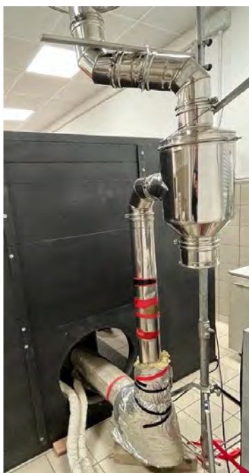
Figura 3. Sistema a Ciclone Passivo.
