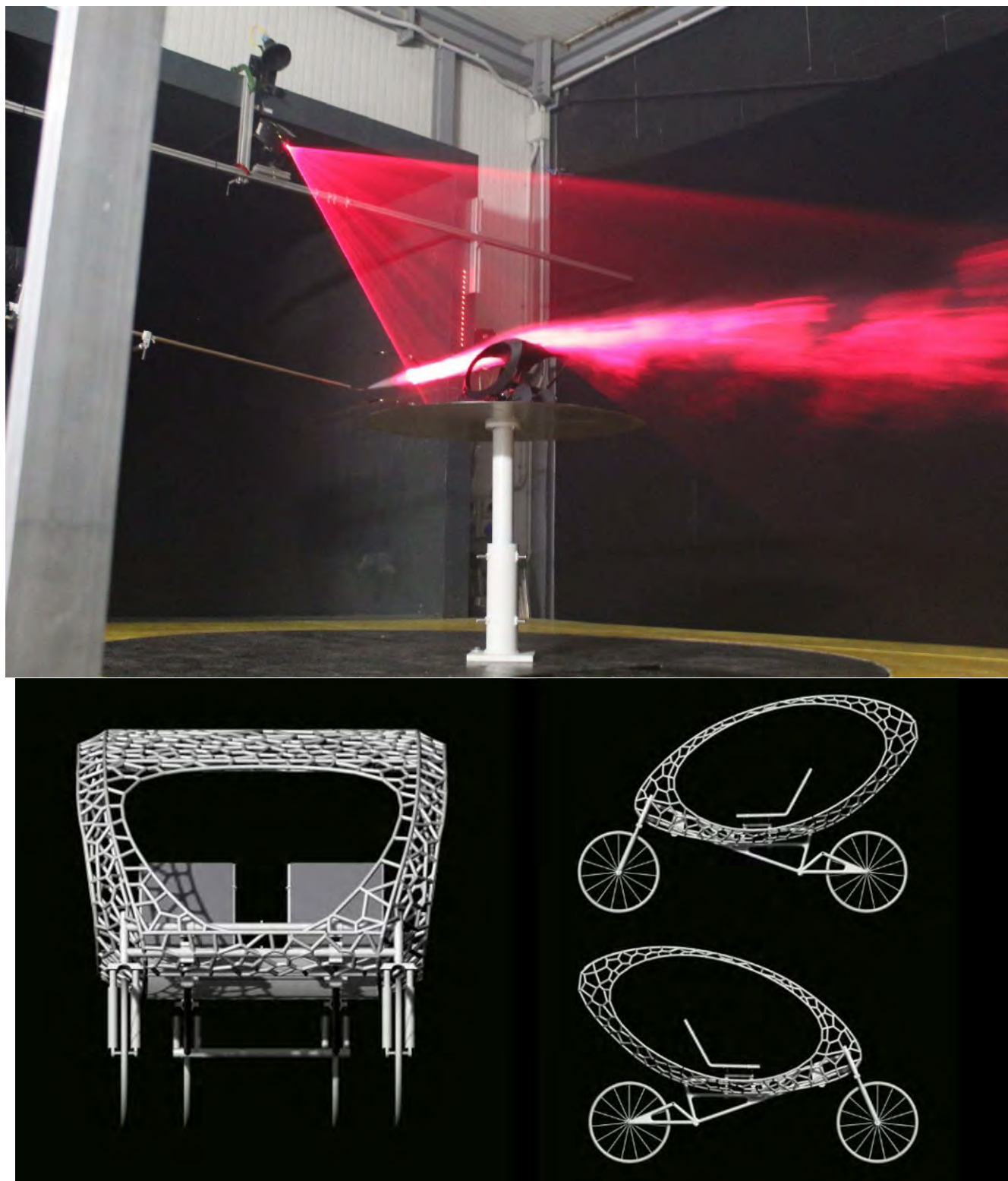
Figura 4. Modello stampato in 3D testato nella galleria del vento. Modello ottimizzato in funzione dei dati ottenuti in galleria del vento.
