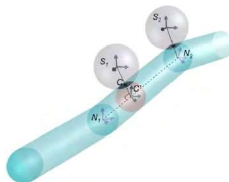
Figura 3. Geometria delle interazioni tra una sfera e i cilindri tra loro collegati in un modello discreto relativo alle radici [17].
