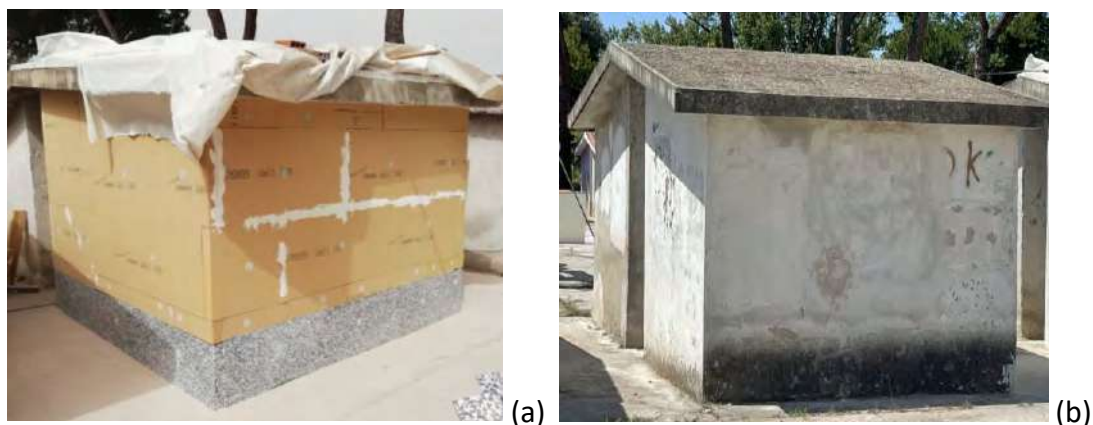
Figura 3. Edificio test isolato con pannelli in fibra di legno (a) e di riferimento (b).
