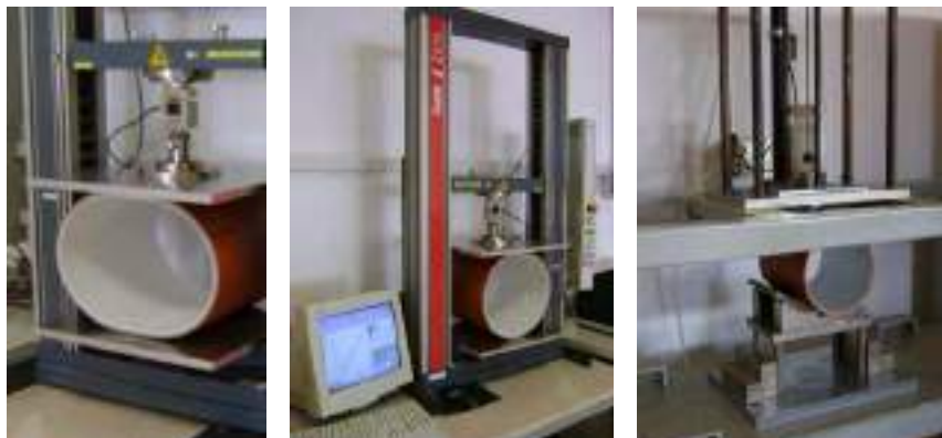
Figura 7 – Rappresentazione schematica dei test di laboratorio per la determinazione della rigidità e della flessibilità anulare
