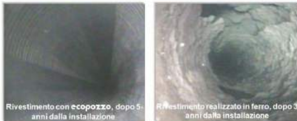
Figura 12 – Confronto tra installazione di tubo Ecopozzo e tubo in acciaio per la realizzazione di un pozzo termale nell’Isola di Ischia a distanza di qualche anno
