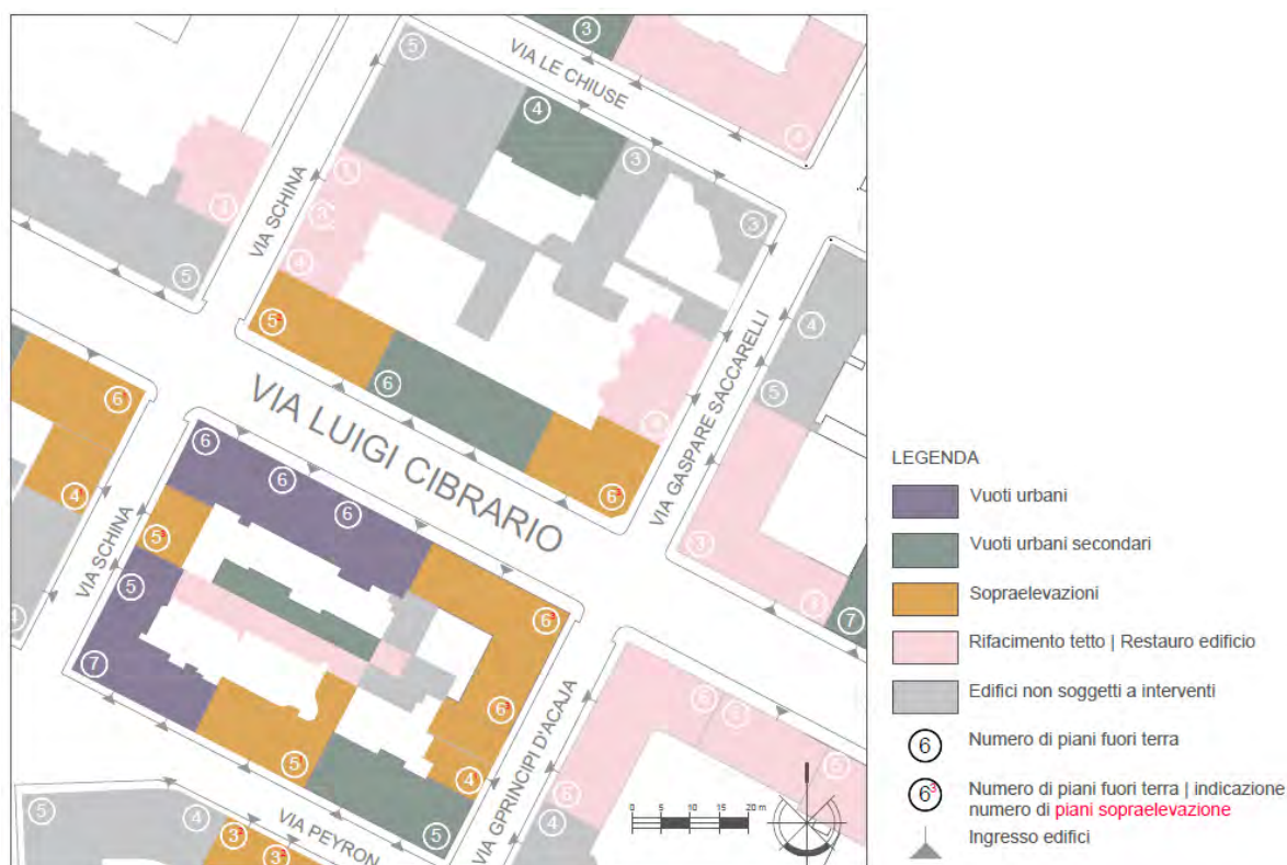
4: Rilievo urbano di alcuni lotti in prossimità di Via Cibrario.: tematizzazione delle tipologie di intervento a cui gli edifici sono stati soggetti nel periodo post bellico.
