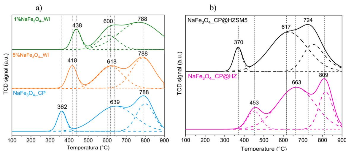
**Fig. 6** – H<sub>2</sub>-TPR profiles of fresh catalysts: (a) 1%Na-Fe<sub>3</sub>O<sub>4</sub>\_WI, 5%Na-Fe<sub>3</sub>O<sub>4</sub>\_WI 5%Na-Fe<sub>3</sub>O<sub>4</sub>\_CP; (b) NaFe<sub>3</sub>O<sub>4</sub>\_CP@HZSM5 and NaFe<sub>3</sub>O<sub>4</sub>\_CP@HZ.
