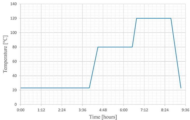
Fig. 3. Curing ramp
