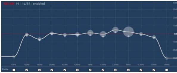
Figura 2 - Firma spettrale rappresentata dalla linea bianca continua e dal guadagno massimo (cerchio bianco) per ogni frequenza centrale delle bande di un terzo di ottava per il filtro Heavy. Le frequenze centrali delle bande di un terzo di ottava sull'asse x sono da 63 Hz a 16 kHz, prese una ogni due.
