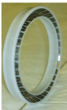
Figure 3: Dimensioni della guarnizione a labbro commerciale in PTFE usata per le prove e della relativa sede di montaggio sul pistone pneumatico.
