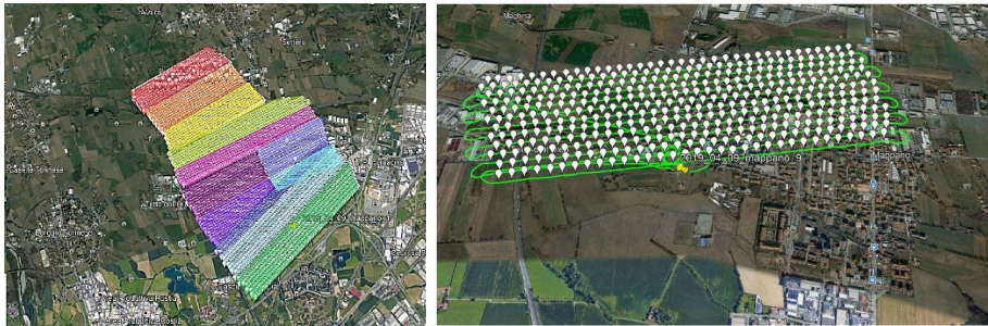
Fig. 1. I voli eseguiti e un esempio di schema di volo eseguito sopra il Comune di Mappano
