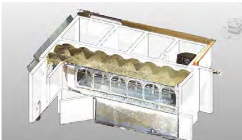
Figura 12 Ricostruzione semi-automatica delle murature tramite plug-in.
