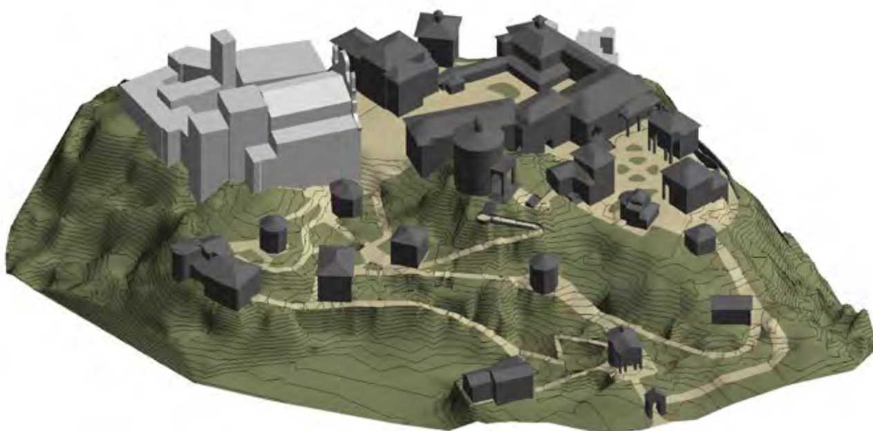
Figura 13 Modello del terreno del Sacro Monte di Varallo ricostruito in Revit a partire dalla nuvola di punti.
