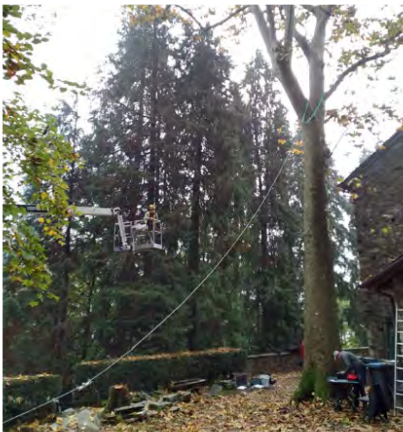
Figura 11 e 12 Prove di Pulling test dove è visibile il cavo su cui andrà misurata la tensione e la resistenza radicale della pianta, il tirfort posizionato al colletto e il risultato che restituisce lo strumento di analisi.
