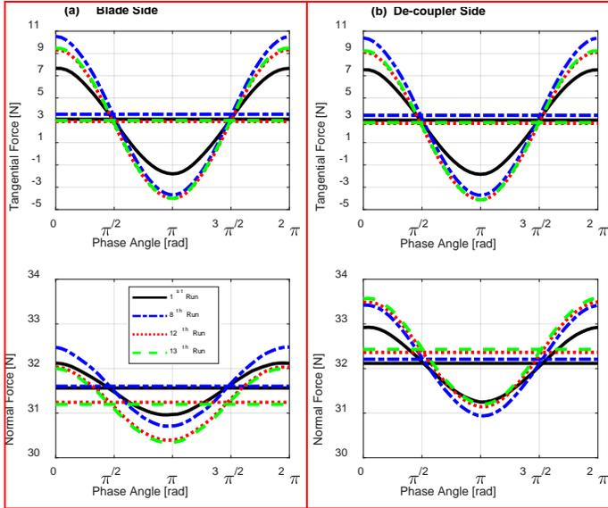
**FIGURE 10:** CONTACT FORCES ON THE RIGHT DAMPER FOR THE 4<sup>TH</sup> SUBSET ( $F_{EXC} = 5$  N,  $CF = 6.6$  kg)
