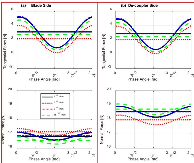
**FIGURE 11:** CONTACT FORCES ON THE RIGHT DAMPER FOR THE 3<sup>RD</sup> SUBSET ( $F_{EXC} = 1$  N,  $CF = 3.6$  kg)
