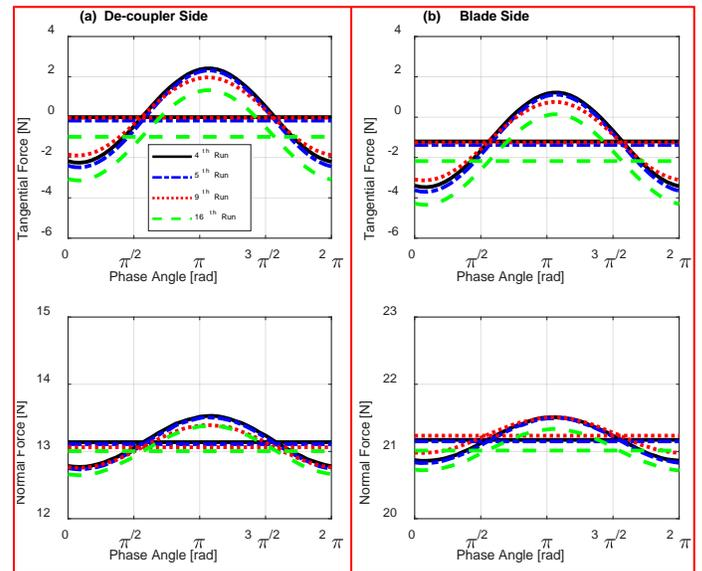
**FIGURE 12:** CONTACT FORCES ON THE LEFT DAMPER FOR THE 3<sup>RD</sup> SUBSET ( $F_{EXC} = 1$  N,  $CF = 3.6$  kg)
