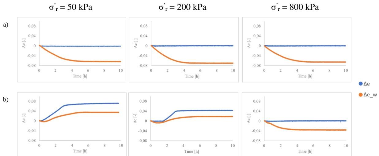
Fig 2. Risultati sperimentali: variazione dell'indice dei vuoti  $\Delta e$  e  $\Delta e_w$  in fase di congelamento. a) Campioni sabbiosi; b) Campioni sabbiosi con 15% di caolino.
