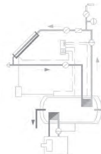
Schema di impianto solare termico
