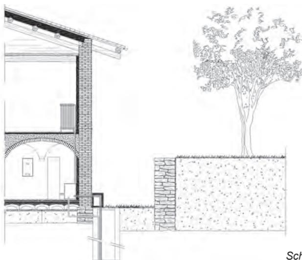
Schema di impianto geotermico.
