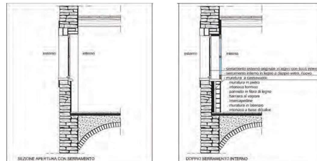
la lastra esistente, pulitura del telaio ed eventuale consolidamento, posizionamento e fissaggio della vetrata isolante, integrazione o sostituzione delle guarnizioni di tenuta.
