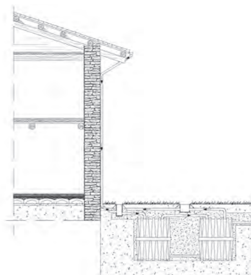
Schema di impianto di recupero dell'acqua piovana.
