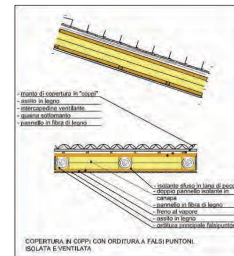
realizzazione di un pacchetto di copertura consiste nella posa del manto di copertura. Il fissaggio del manto deve sempre avvenire a secco, mediante tecniche che favoriscano interventi di manutenzione ordinaria e la sostituzione degli elementi danneggiati. Se la copertura è fortemente esposta al vento è opportuno fissare tutti gli elementi in corrispondenza dei bordi della falda, delle linee di colmo e del perimetro degli elementi emergenti.
