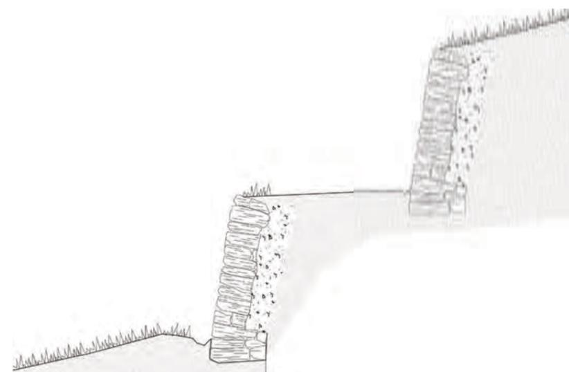
dere agevole la percorrenza del sentiero per una larghezza minima di m. 0,70 compreso il taglio di radici ed il successivo riporto del terreno a valle con profilatura delle scarpate con idonee pendenze. Il cotico erboso deve essere asportato con cura, accantonato e riutilizzato per la formazione dei nuovi profili delle scarpate. (...)
