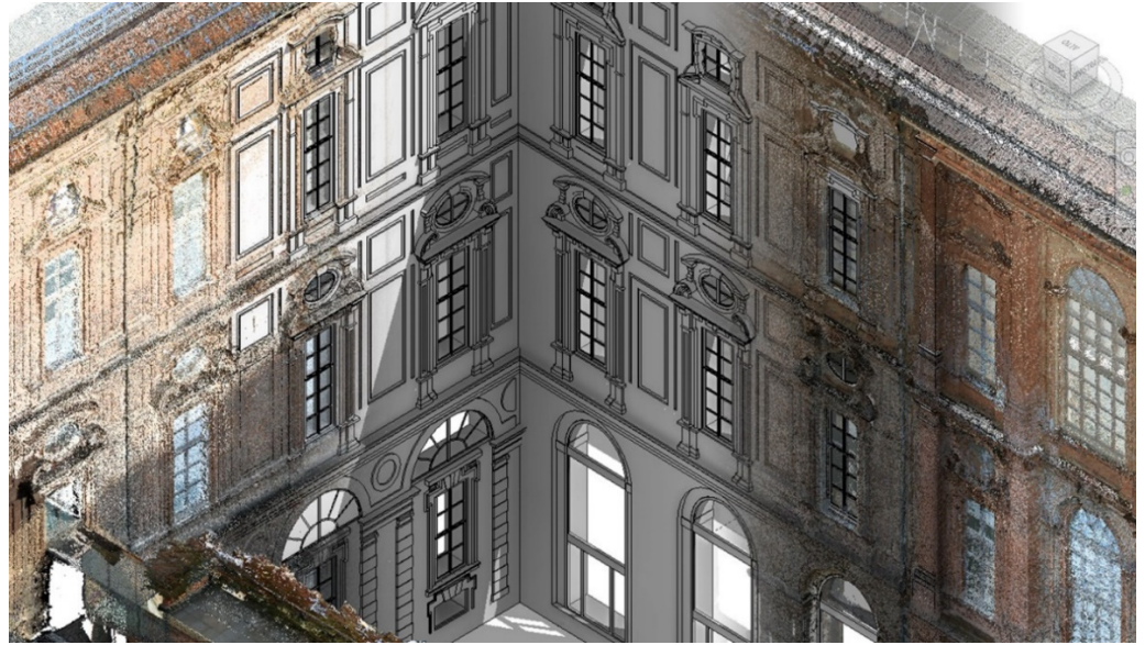
Figure 1. From the point cloud to HBIM model. Virtual model of the Fondazione Museo delle Antichità Egizie di Torino.
