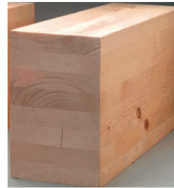
Sezione di legno lamellare da http://arredamento-online-glossario-figurato.blogspot.com/2015/05/legno-lamellare-incollato.html
