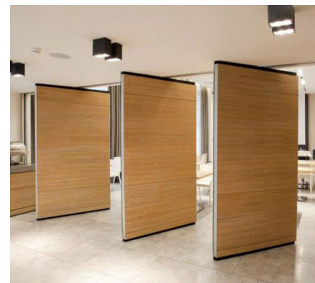
Esempio di parete manovrabile lungo un binario a soffitto da https://www.infobuild.it/approfondimenti/ristrutturazioni-flessibilita-pareti-mobili/
